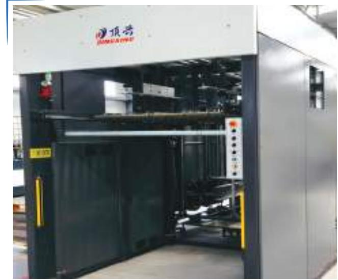
Ofset baskılı A-Box Kutu ve Koliler fabrikamızda ondüle hattımızda açık ondülesi imal edilen koliler, ofset makinasında basılan ofset karton ile hızlı sıvama makinemizde laminasyonu yapılarak hızlı kesim makinesinde kesilip otomatik yapıştırma makinesinde yapıştırılarak koli haline getirilip sevk edilir.
